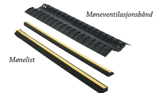
Møneventilasjonsbånd/mønelist Benyttes over mønekam. Tetter mot inndrev, men slipper ut luft. Dekkes av mønekappe.
