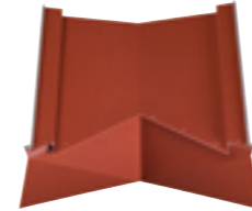
Kilrenne-begynnelse Start av vinkelrenne ved takfot. Leder vann fra kilrenne og ned i takrenne. Farge: sort, rød.
