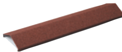
Rett møne/valmkappe Dekkende lengde 900 mm. Møne-valminndekning for fall fra 10° til 18-20°.
