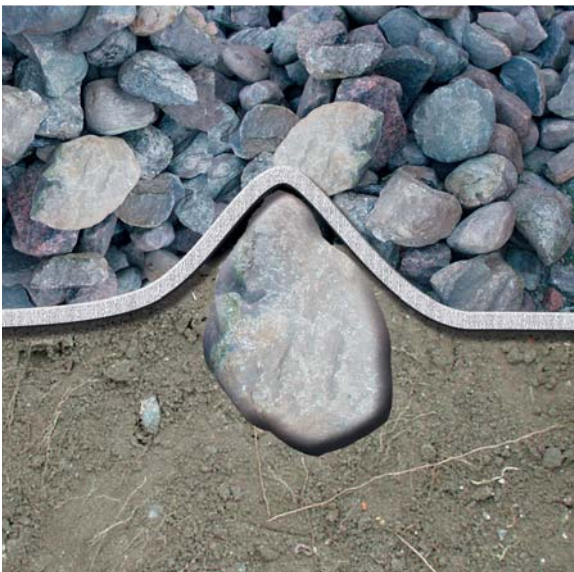
Fig. 5. Stor forlængelse og statisk perforeringsmodstand tillader geotekstilet at tilpasse sig til den ujævne konstruktionsoverflade.
