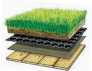
Oppbygging av torvtak.
