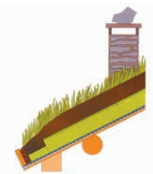
Prinsippkisse for varmtaksløsning (Rockwool Torvtaksplate)
