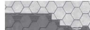
Illustrasjonene viser monteringsprinsipper for ny takshingel type Skrå på gammel Skrå
