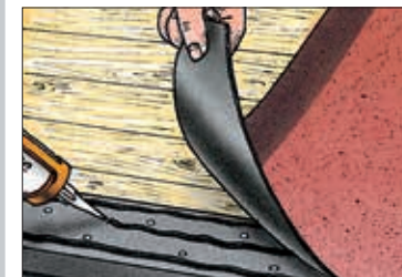
Monteringsprinsipp for feste av takbelegg ved takfot
