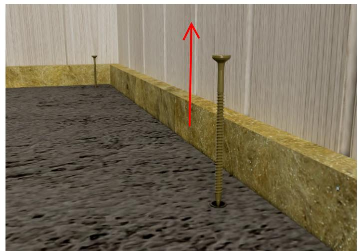
Platene festes midlertidig langs kantene for å hindre kantreis under betongens herdeprosess. Dette kan gjøres med 50mm lange hylser, og skruer gjennom disse. Plassering på annenhver bjelke i lengderetning og på plateskjøtene i endene.
