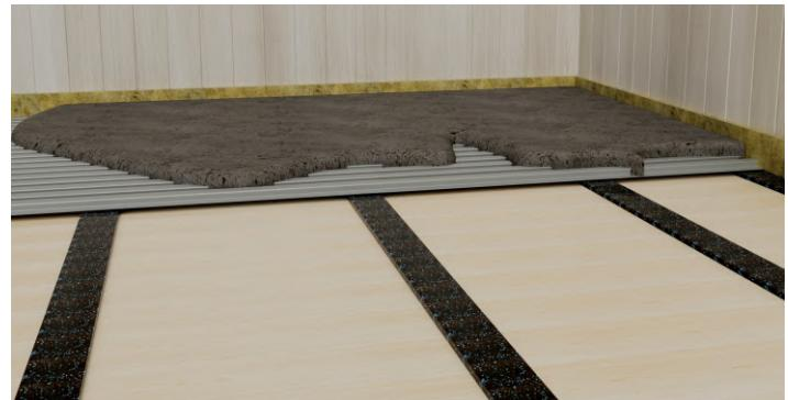
Trinnlydstrimler legges direkte på bjelkene eller på gammelt bord/sponplate gulv, i samme retning som bjelkene, og med senteravstand 60cm. NB! Bruk kun **midlertidig innfesting** langs kantene, når det brukes trinnlydstrimler.
