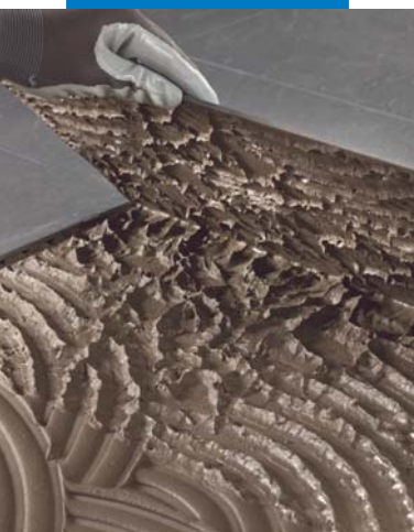
Kontroll av dobbeltliming på tynne, glaserte porselenatfliser
