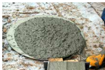
Godt flytende T-betong; utbredelse min. 550 mm
