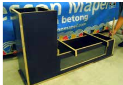
L-boks for testing av Rescon T ®
