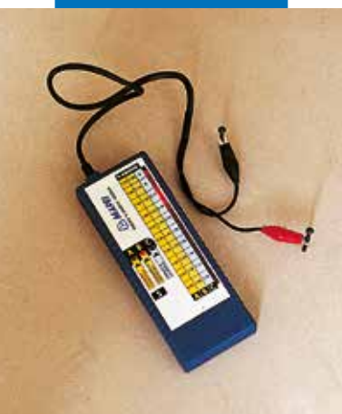
Elektronisk hygrometer til måling af fugtniveauet i Mapecem afretningslag
