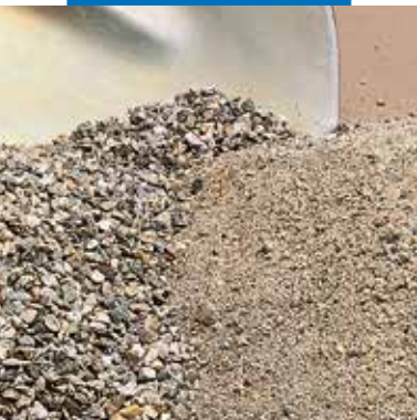
Tilslag til Mapecem: Grus fra 4 til 8 mm og sand fra 0 til 4 mm
