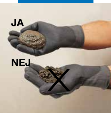
Den korrekte konsistens på Mapecem
