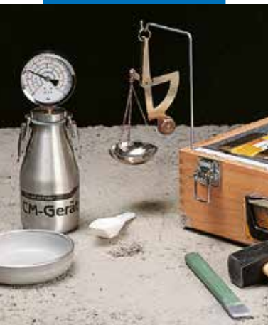
Karbidhygrometer til måling af fugtniveauet i Mapecem afretningslag
