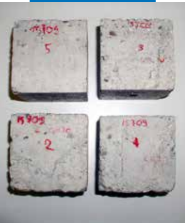
Virkning etter fryse- tine-sykluser på prøve behandlet med Planiseal WR 90 Gel
