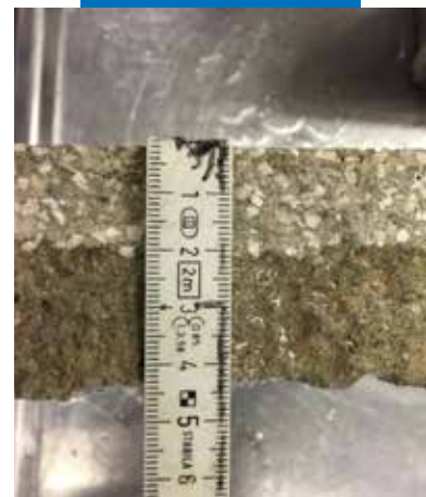
Penetrasjonsdybden av Planiseal WR 90 Gel
