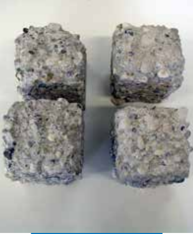
Virkning etter fryse- tine-sykluser på prøve uten behandling
