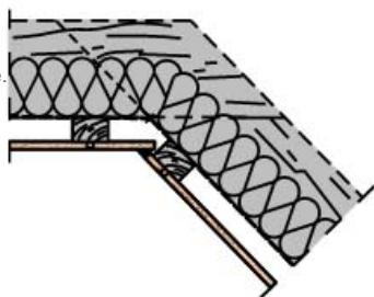
Fig. 3: Skjøten er fylt ut med overmalbar fleksibel fuge.
