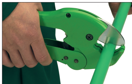
Kapping av røret
