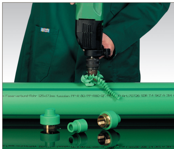
Gjennom boring av rørveggen
