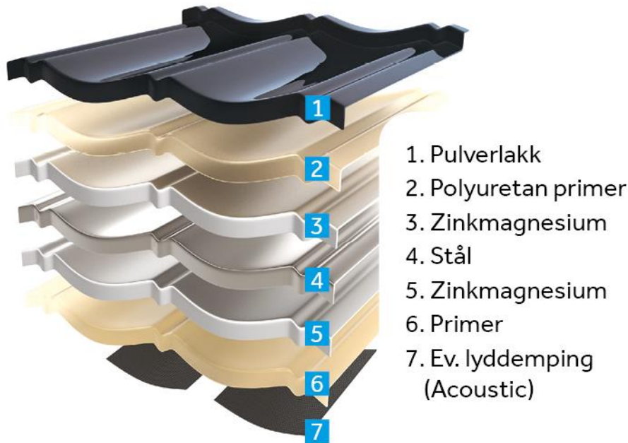
Figur 1, oppbygning av AeroDek Unique Plus
