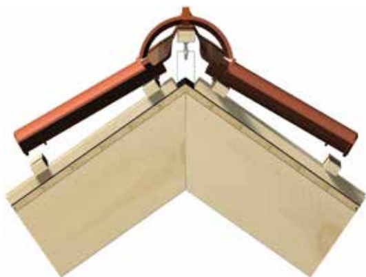
Bilde 10. Det er viktig at møne og valmtettingsrullen ikke ligger mot sidene på mønekammen, kun på toppen. Da får du best utluffing.
