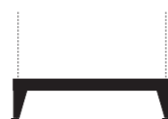
Helsveiset benramme med justerskruer Høyde 145 mm. Farge RAL 7021.
