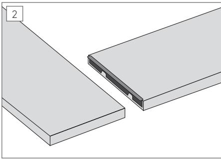
Underlaget må være plant og det må justeres for ulikhet i tykkelse på benkeplate. For skjøter kan det benyttes dekklist. Sponflatene forsegles med fugemasse.
