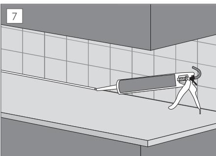
Utskifting av benkeplate ved oppussing: Hvis det er fliser på veggjen mellom benk og overskap, kan det være en fordel om benkeplaten monteres utenpå disse. Dette vil gjøre det lettere å bytte plate senere uten å skade flisene. OBS! Før benkeplaten skyves på plass må det være igjen en spalte på ca 3-5 mm. Påfør en stripe fugemasse. Skyv platen på plass og fjern overskytende fugemasse med Fibo Clean og fugekloss (Fibo Fug).
