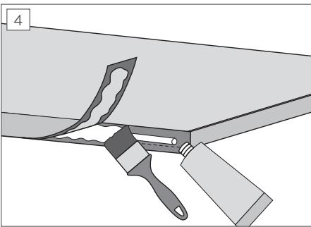
Puss sagsnittet med en trekloss og sandpapir. Bruk pensel til å påføre jevnt 3 lag våt med lim på sponflatene, og ett lag på baksiden av kantlisten. Når limet er støvtørt settes de to flatene sammen. Se også anbefalinger fra leverandør om kontaktilm. Vær nøyaktig med posisjonering slik at listen treffer toppen av benkeplaten. Bruk jevnt trykk. Sørg for å ikke stenge inne luftbobler.
