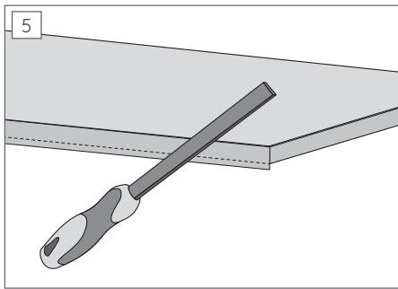
Vent så 6 timer for å være sikker på at limet er tilstrekkelig herdet. Overskytende del av listen på toppen pusses så den blir jevn. Stryk filen fra deg for å ikke dra i listen. Overflødig kantlist i bunnen kan kuttes bort med tapetkniv.
