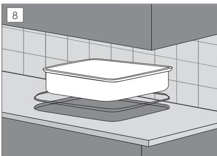
Ved utskjæring for vask benyttes utskjæringsmal fra vaskleverandør. Følg denne anvisningen nøyde. Benkens innerkant må forsegles med Fibo Seal. Vær meget nøyde med å få overgang mellom vask og benkeplate tett. Bruk medfølgende gummi-/plastlist fra vask-leverandør. Hvis tetningslist ikke kan skaffes, tetter man overgangen best ved bruk av Fibo Seal.
