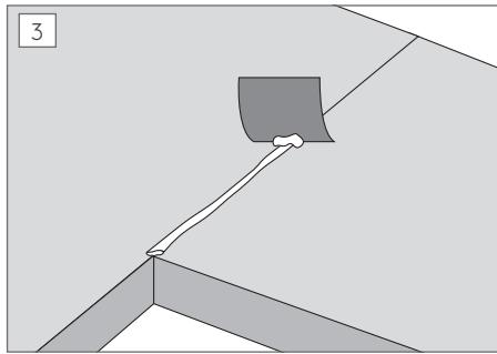
Høydejustering i skjøt/hjørne underveis. Det skal benyttes lim/fugemasse i skjøtene for å holde dem vanntett, så det ikke sveller når utsatt for vann. Overflødig masse kommer på oversiden og fjernes med fugekloss, Fibo Clean og Fibo Wipes. Alle skjøter skal understøttes og monteres parvis med skruer.
