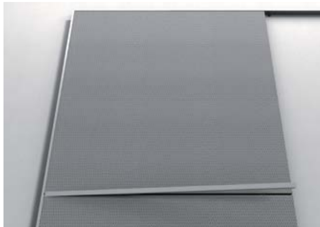
3.6 Skjul de vannrette samlingene mellom platene ved å klikke T24-profiler på plass i montasjebeslag 40, og kjør dem deretter forsiktig inn under rammeprofilen. Disse vannrette T-profilene skal tilskjæres nøyaktig til M-12 mm.
