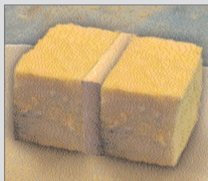
Trekonstruksjon isolert med 150 mm glassull før test.
