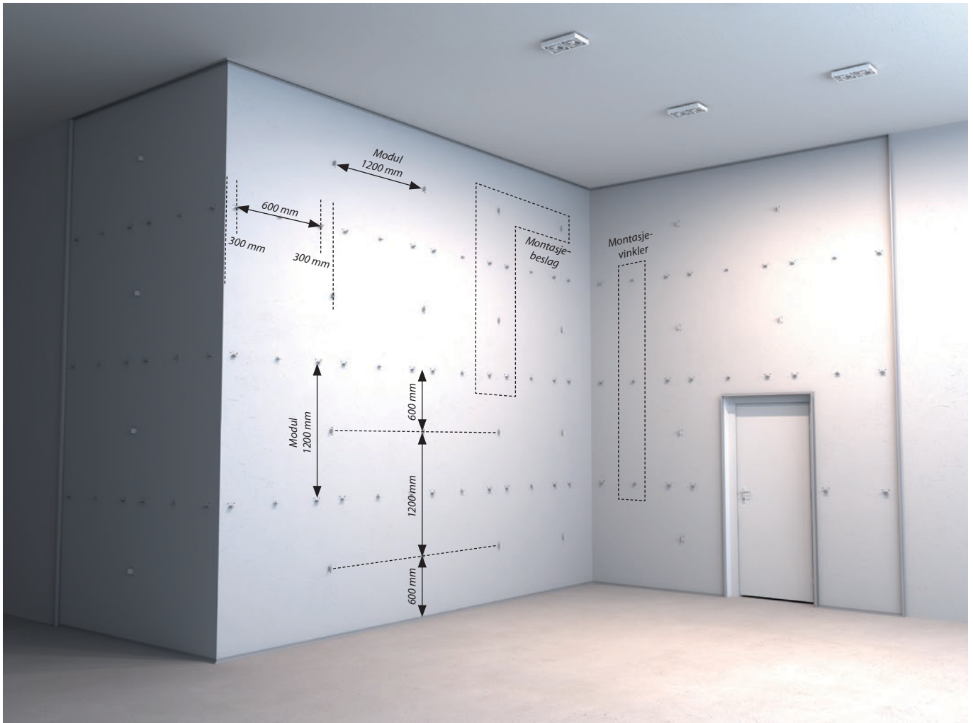
2.1 Plasseringen av alle montasjebeslag 40 og montasjevinkler bør måles til og monteres, før platene monteres. Dette vil redusere montasjetiden betydelig. Det skal sikres, at alle montasjebeslag 40 og montasjevinkler tilpasses: Montasjebeslag 40 sentreres i modullinjen og montasjevinklernes underside plasseres 4 mm over modullinjen.
