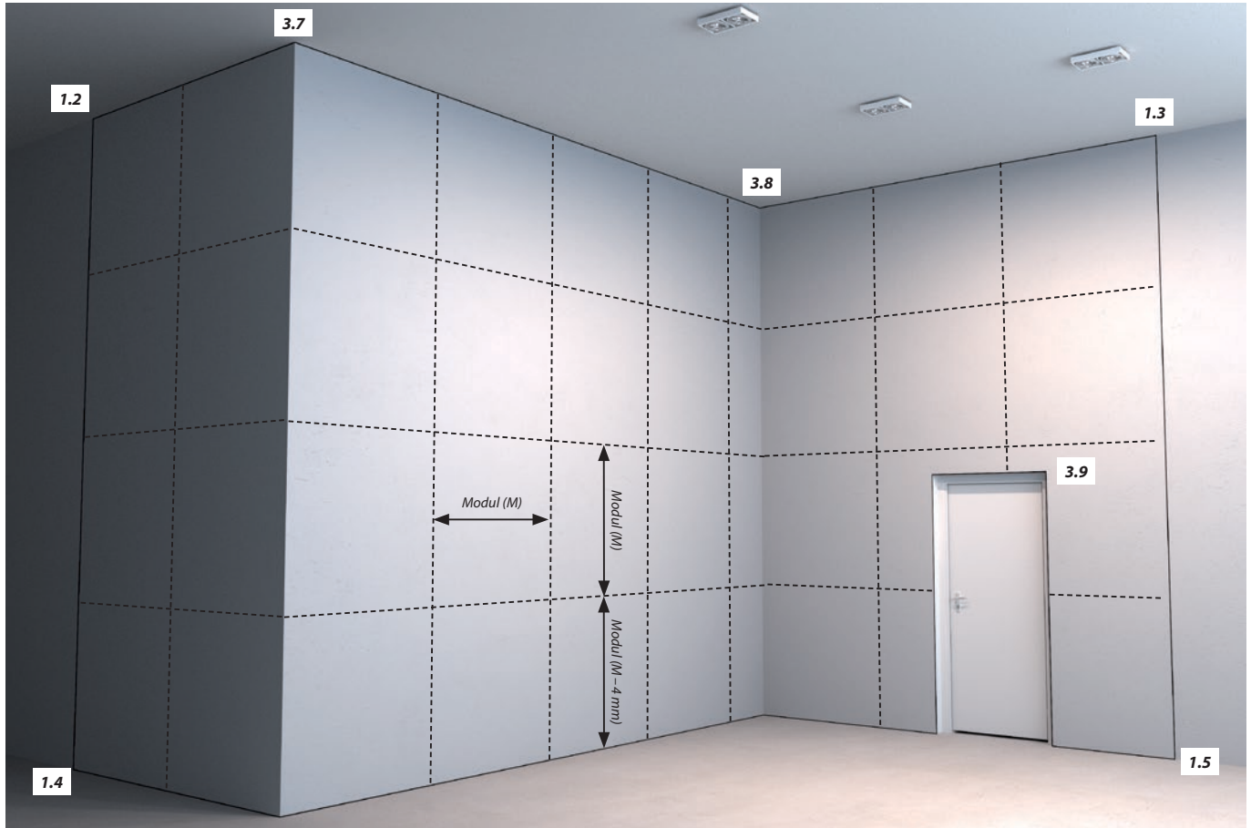
1.1 Merk av plasseringen av rammen og T24-profilene tilsvarende modulmål. U-profilen i bunnen plasseres 4 mm over modullinjens plassering dvs. M-4 mm.
