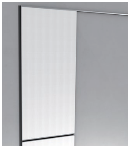
6.2 Ved montasje av plater i flere nivå skal den neste platen plasseres over og skjule den/de vannrette skjøtene mellom platene med en 40 mm hatteprofil med en nøyaktig lengde på M-52 mm (se diagram på side 15), som festes ved platens midte (figur 6.4). Det skal sikres at kantene på platene er skjult i rammen (U- eller hatteprofil) og av hatteprofilene i plateskjøtene.
