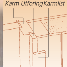
Panel mot dør/vinduskarm
