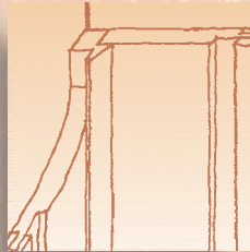
Stående panel, innvendig hjørne, med hjørnelist
