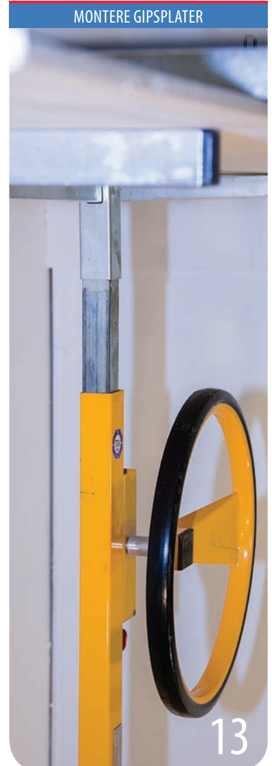
Monteringen av platene blir mye lettere ved bruk av en plateheis. For å oppnå det beste resultatet: monter Norgips Plan som ytterste lag.
