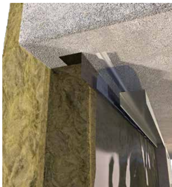
Dampsperre mekanisk klemming/dobbel
