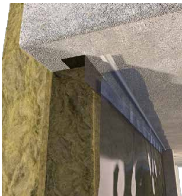
Dampsperre mot betong/dobbel
