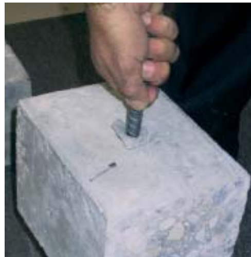
Armeringsjernet monteres ved håndkraft
