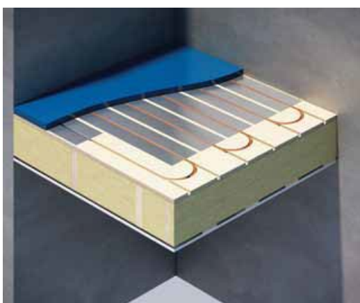
Fig. 3 Wavin gulvvarme lagt i spor i Wavin varmfordelingsplate og Wavin Huntonplate på et stabilt undergulv av tre eller betong. Figur: Wavin
