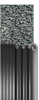
2. Fyll opp med masse og komprimer
