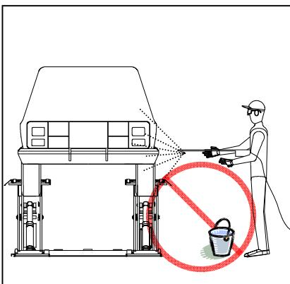
Es ist verboten die Hebebühne dazu zu verwenden, um Behälter auf die Transportmittel zu laden oder die Hebebühne als Lastenaufzug zu verwenden.
