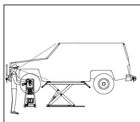
Es ist notwendig, das Fahrzeug so auf die Fahrschiene positionieren, dass die Lastenverteilung so erfolgt, wie es im Lastenaufteilungsschema dargestellt steht.
