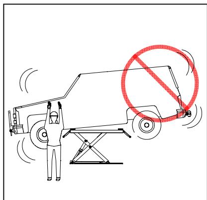
Løfting av et kjøretøy med motoren i gang er forbudt.
