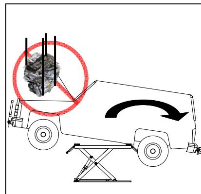
Vor dem Heben oder Senken muss sichergestellt werden, dass die Stabilität des Systems Hebebühne-Fahrzeug befriedigend ist.
