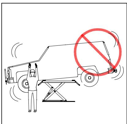
Het is verboden een voertuig met draaiende motor op te tillen.
