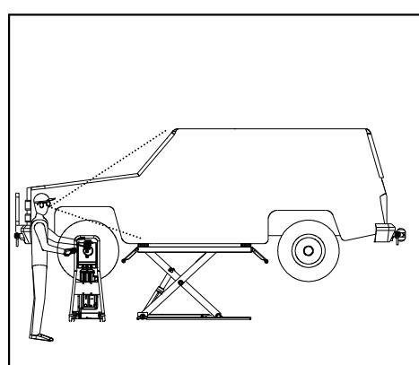
Det er påkrævet at placere køretøjet oven på løfteplatformene, så fordeling af vægten bliver som angivet i oversigten over belastningsfordelingen.
