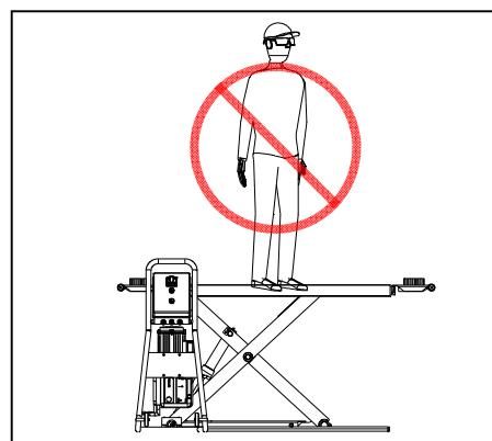
Es ist verboten, während des Hebens und Senkens oder bei angehobenem Fahrzeug dies zu besteigen.
