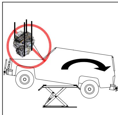
Inden liften løftes eller sænkes, er det påkrævet at kontrollere stabiliteten af hele systemet (lift og køretøj).
