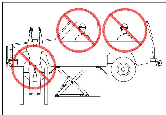
Es ist verboten, während des Hebens und Senkens der Hebebühne ein Schaukeln des Fahrzeugs zu provozieren.
