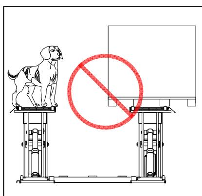
Het is verboden de hefinrichting te gebruiken voor het reinigen van de voertuigen.
