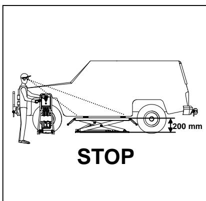
Vor jedem Betreten des Risikobereichs muss die Hebebühne durch Umschalten des Schlüsselschalters auf „OFF - 0“ von den Energiequellen getrennt werden.
