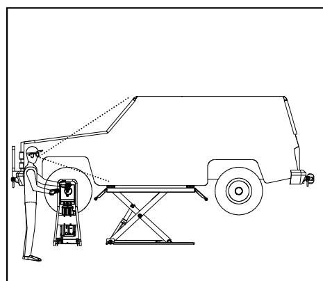
Het is verplicht het voertuig boven de platformen van de hefinrichting te brengen, zodat de verdeling van de ladingen overeenstemt met het schema van de verdeling van de lading.
