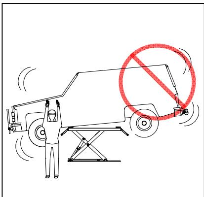
Es ist verboten, ein Fahrzeug mit laufendem Motor anzuheben.
