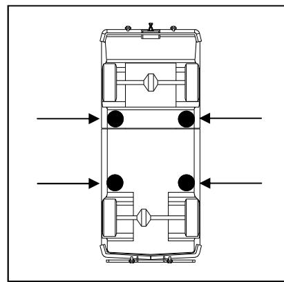
Es ist sicherzustellen, dass der Fußboden auf dem die Hebebühne installiert wird solid, eben und perfekt geebnet ist, um den vorgesehenen Höchstladungen standzuhalten.
