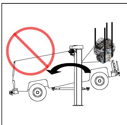
È obbligatorio prima di effettuare la discesa del sollevatore verificare che la zona posta sotto o in prossimità del veicolo, dei bracci porta carico e del carrello sia libera da impedimenti, oggetti o attrezzi che possano interferire con il movimento.
