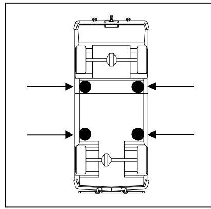
Het is verplicht na te gaan of de grond waarop men de hefinrichting wenst te installeren, stevig, vlak en perfect genivelleerd is en in staat de voorziene maximale ladingen te dragen.
