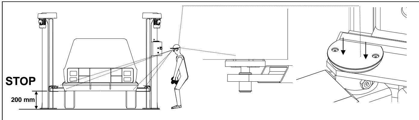
Vor jedem Betreten des Risikobereichs muss die Hebebühne durch Umschalten des Schlüsselschalters auf „0“ (OFF) von den Energiequellen getrennt werden.
