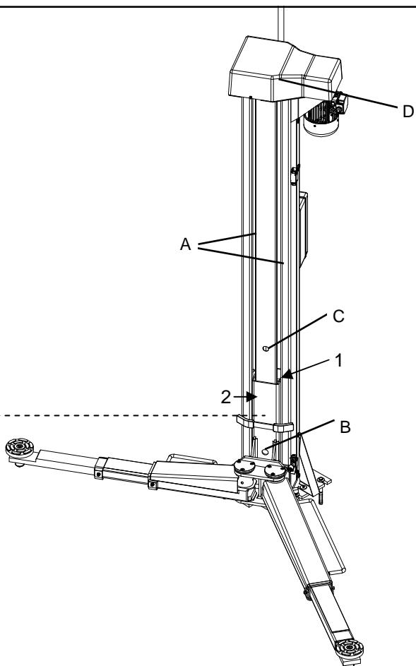
Per entrambe le colonne: attraverso l'apposito ingrassatore, ingrassare la chiocciola (3). Per poter effettuare questa operazione arrestare i carrelli quando il foro predisposto sul carrello (B) coincide con il foro presente sul carter (C).
