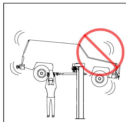
Het is verboden de hefinrichting voor eender welke reden te verlaten, zonder eerst de spanning uitgeschakeld te hebben, aan de hand van de daarvoor bestemde schakelaar.
