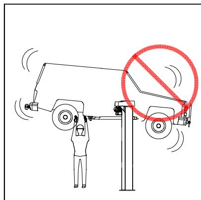
Es ist verboten, sich von der Hebebühne aus irgendeinem Grund zu entfernen, ohne die Hebebühne durch Betätigung des entsprechenden Schalters spannungsfrei geschaltet zu haben.
