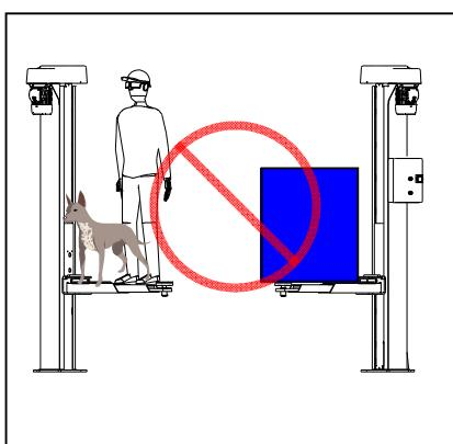
Es ist verboten, während des Hebens und Senkens oder bei angehobenem Fahrzeug dies zu besteigen.
