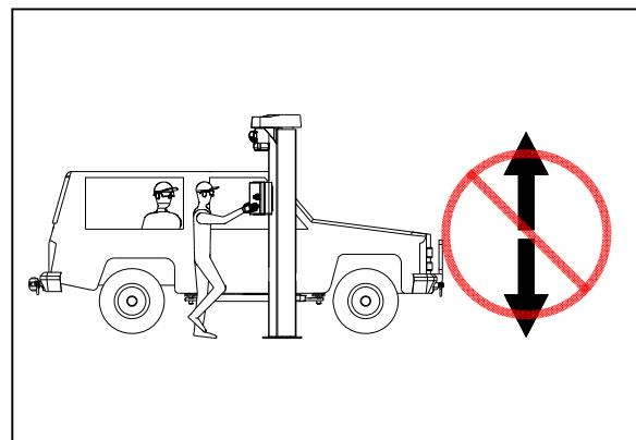
Es ist verboten die Hebebühne dazu zu verwenden, um Behälter auf die Transportmittel zu laden oder die Hebebühne als Lastenaufzug zu verwenden.
