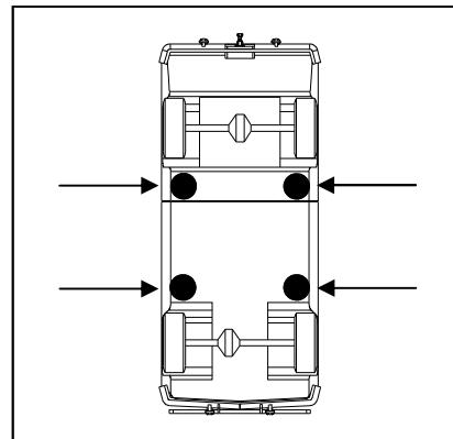
Det er pålagt å kontrollere at gulvet der man vil montere løftebukken er solid, flatt, perfekt utjevnet og at det kan tåle de forutsette maks. belastningene.
