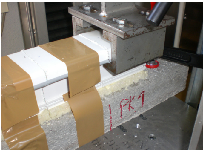
Bild 7 Prüfaufbau zum Zugversuch
