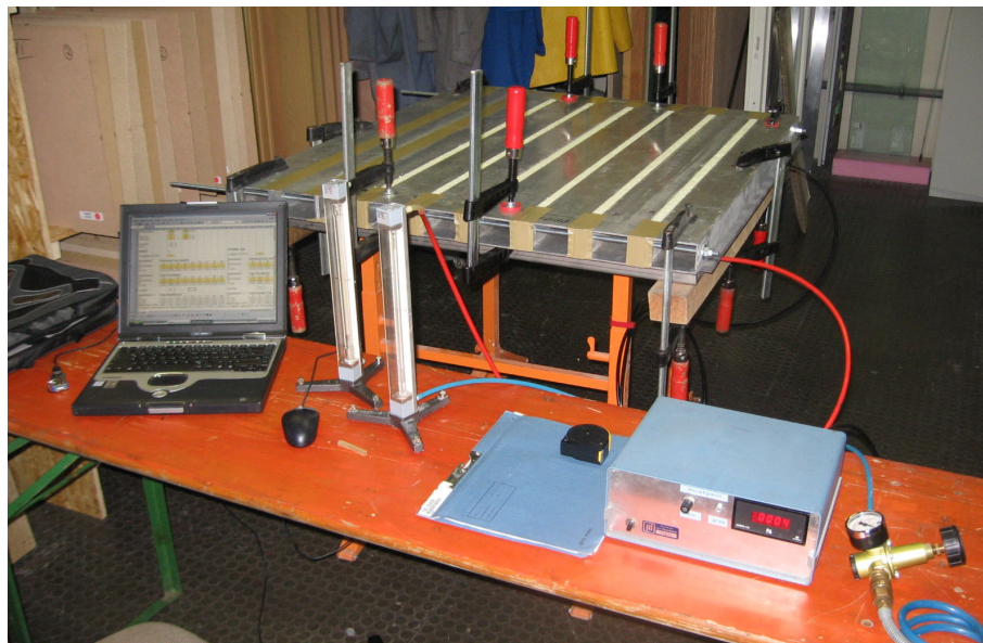
Abbildung 2 Messeinrichtung mit Durchfluss- und Druckmesseinheit.
