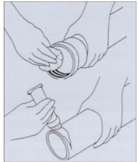
Figur 8. Rengjøring og smøring
