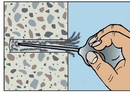
Rengjøring av borehull
