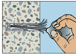
Rengjøring av borehull
