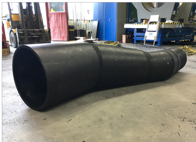
Eksentrisk reduksjon fra 500 mm til 300 mm
