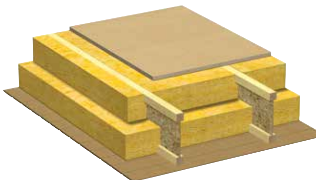
Fig. 1 Bjelkelag Masonite gulvbjelker fullisolert med himling festet rett til gulvbjelkene 1).
