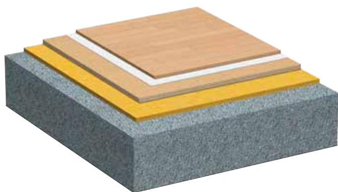
Fig. 1 Dekker. Flytende gulv på lettklinker
