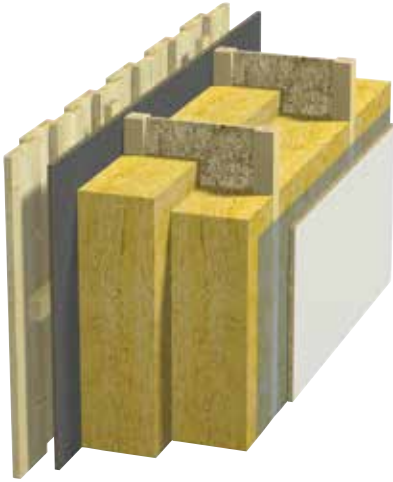
Fig. 3 Yttervegg Masonite stender, vindsperre 12mm trefiberplate
