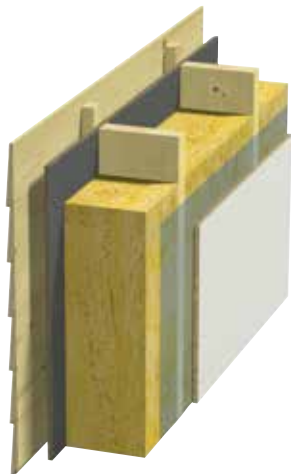
Fig. 8 Yttervegg Heltre stender, vindsperre 12mm trefiberplate.
