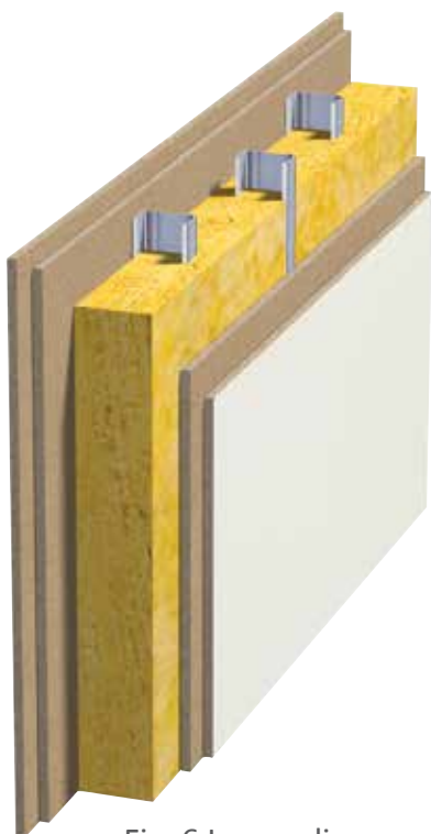
Fig. 6 Innvendig vegg. Forskjøvet stålstender med to platelag
