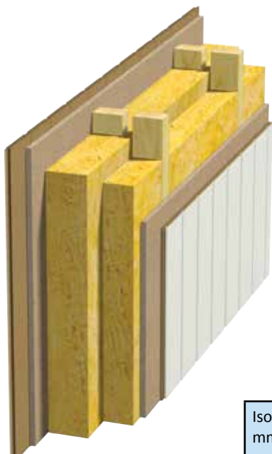
Fig. 4 Innvendig vegg. Dobbel heltre stender. To platelag.
