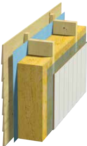
Fig. 5 Yttervegg Heltre stender, vindsperre av folie.
