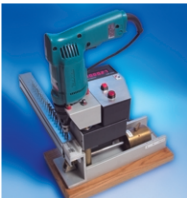
Testapparat benyttet til prøving av gipsskrue i stål
