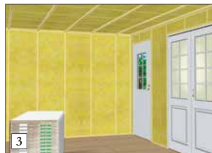
3) Montering skjer vanligvis på langsgående elektrikerlektre med avstand c/c 60 cm. Alle frie platekanter skal understøttes. Ved montering av smalere takplater, må lekteeavstanden justeres slik at de passer til bredden av takplatene.
