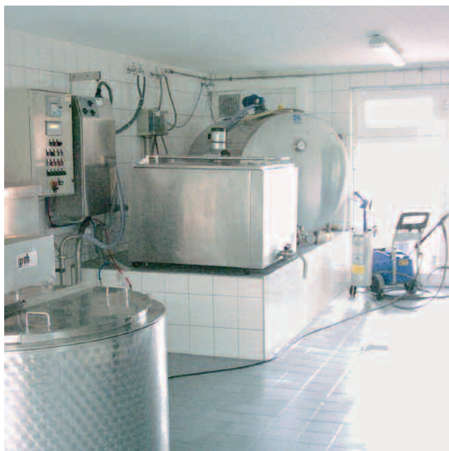
Slitesterk og kjemikaliebestandig legging og fuging av keramiske flater, f.eks. i meieri.
