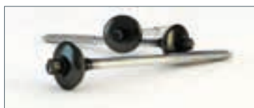
Cembrit 90 Tagskrue 6,0 x 90 mm varmforzinket stålskrue. Pakker á 100 stk.
