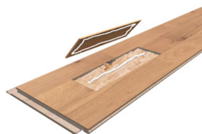
Velg og monter en erstatningsstav. Fyll hulrommet med polyestersparkel og trykk ned staven.
