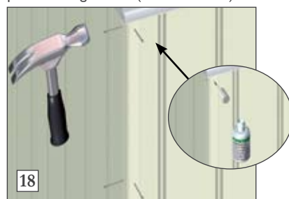
18) Denne stiftes på plass med avstand c/c 300 mm. Stiftene kan skjules med flikkmaling. Flikkmaling leveres i originalfarger for å skjule spiker og utbedre små skader i platene. Flikkemaling bør utføres svært forsiktig da overflatestrukturen blir forskjellig fra ferdigmalt struktur på platen.
