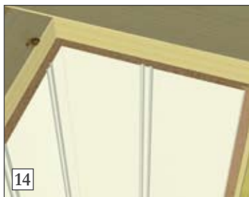
14) Pass på at platen bankes helt inn.
