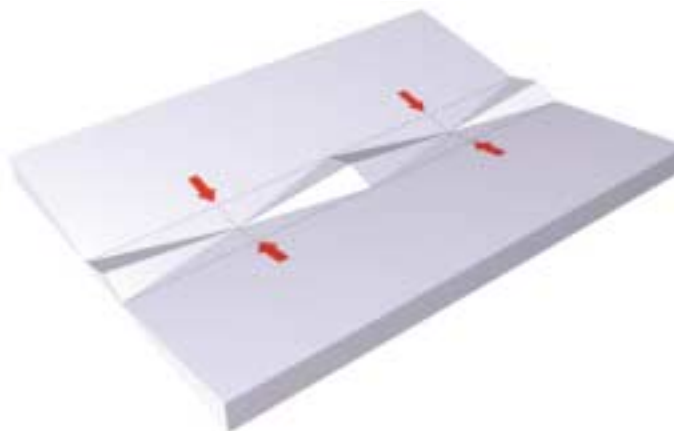
2-veis fall. Selve fallet bygges som en akse som går gjennom ett eller flere sluk.
