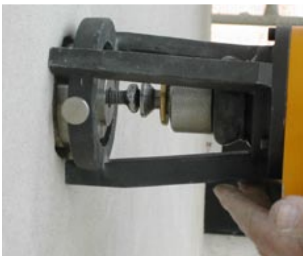
Festebrakett trekkes løs fra underlaget med måleutstyr.
