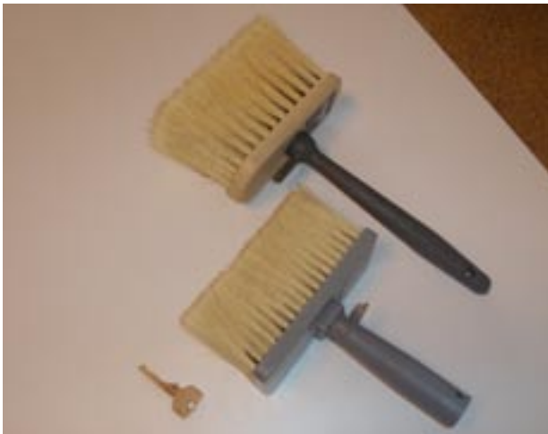
28 Gresskoster. Gode til slemmearbeider.
