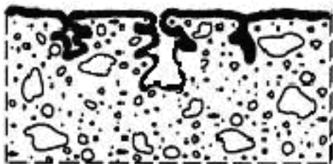
Impregnering reduserer overflatens porøsitet og styrker overflaten. Porene blir helt eller delvis fylt.
