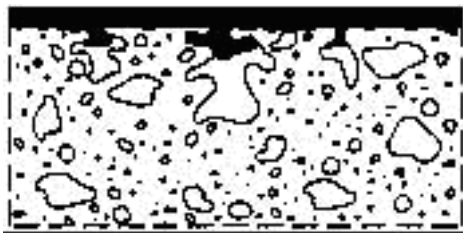
Belegg med tykkelse fra 0,1-5,0 mm gir et heldekkende og beskyttende lag på betongoverflaten. Belegget kan være basert på organisk polymer ev. med sement som filler, eller hydraulisk sement modifisert med polymer dispersjon. Gulvavrettingmasser som skal overføre mekaniske laster, skal i tillegg tilfredsstille kravene i EN 13813 for avrettingsmasser.
