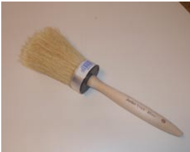
18 Gresskost. Egnert til slemming, forvanning og ettervanning.
