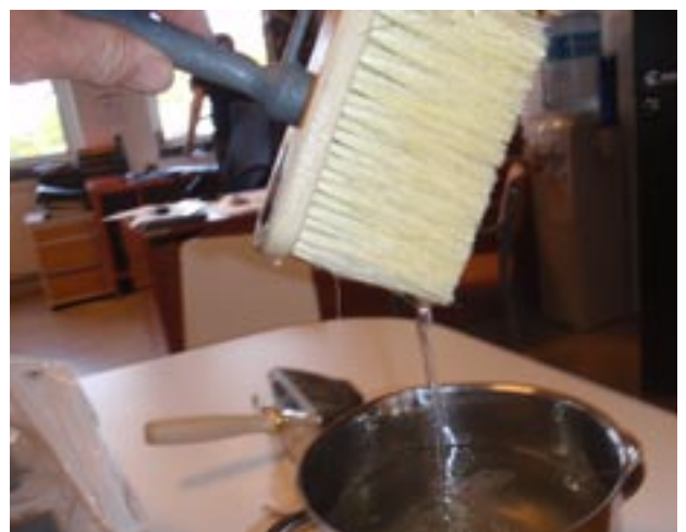
30 Nylon vaskepensel. Ikke så godt egnet til kalking.
