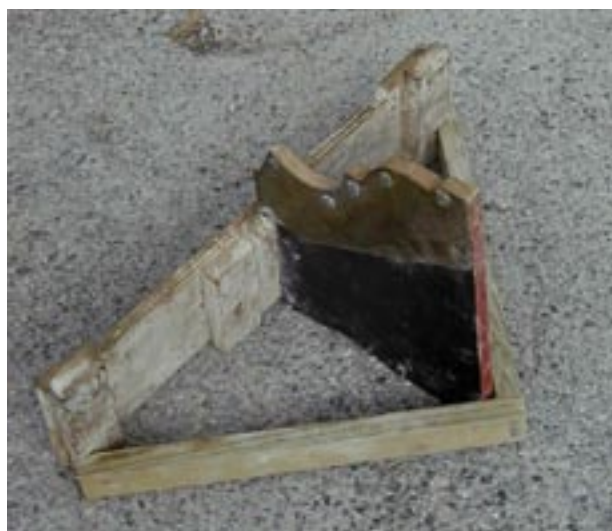
Metallplate montert på slede. Kilde: Murkatalogen P6: 2003.
