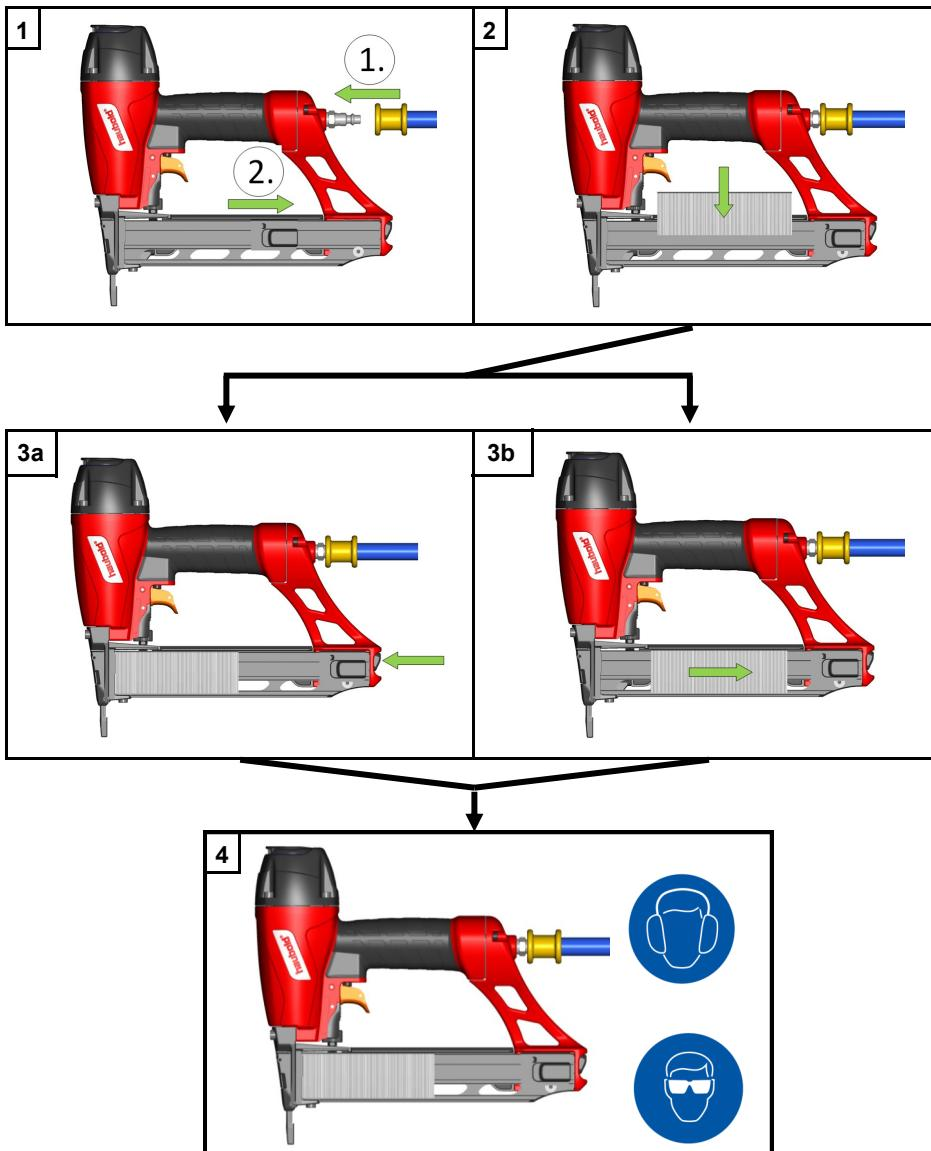
Clearing a jam/ Lösen eines verklemmten Befestigungselementes/ Een storing oplossen/ recherche des pannes/ Desatascar la maquina/ Desatascar la maquina/ Desempenar a máquina/ Eliminazione di un inceppamento/ Hvordan fjerner man evt.
