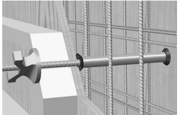
Delle mit Durchlass-Rohr eingebaut
