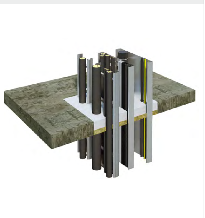
Figur 8. Tykkelse: 100 mm GPG og 50 mm steinull
