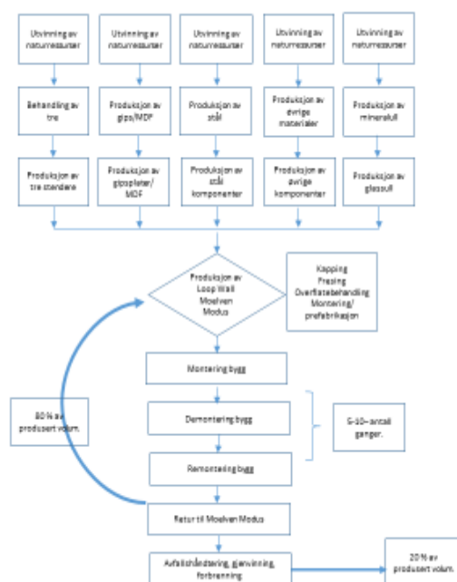
Figur 1. Flytskjema for produksjon av Loop Wall 300 MDF system
