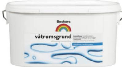
**Våtromsgrunn og lim er en kombineret vannfortynnbar grunning og lim till gipsplater, puss og betong i våtrom. Den brukes til forliming, liming og grunning av strie og filt. Våtromsgrunn gir et tett skikt mot vann og fuktighet. Den har en god vedheft og limingseffekt.**
