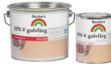
**EPX-V Gulvmaling er en blank, vannfortynnet tvåkomponent epoxy maling beregnet for ny- og om-maling av betonggulv, som utsettes for kjemiske og mekaniske påvirkninger, som f.eks. industri- og lagergulv, garasje og våtrom. Som grunning skal EPX-V Primer benyttes.**
