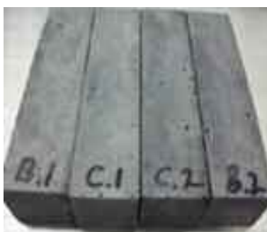
Svart : Jernoksid svart 3 % av sementvekt ( B1,C1), 5 % av sementvekt (C2,B2)
