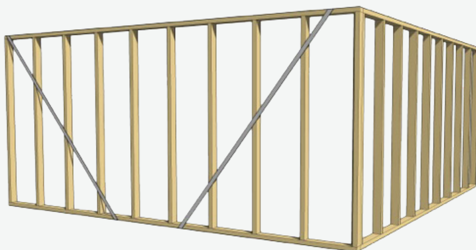
Fig.3: Stagene monteres parvis på veggen. Vinkelen skal være ca. 50°. Hvert stag skal krysse tre stendere.
