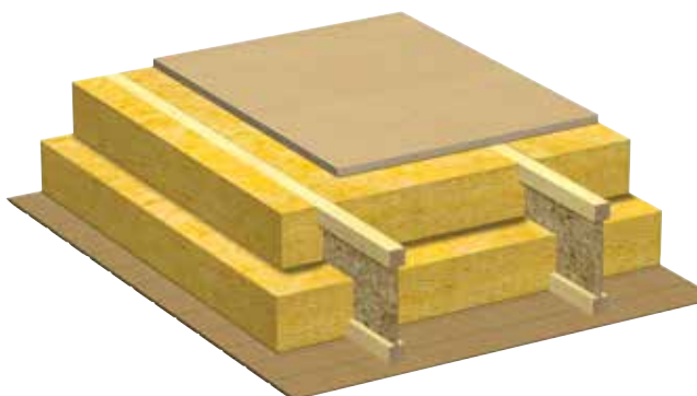
Fig. 1 Bjelkelag Masonite gulvbjelker fullisolert med himling festet rett til gulvbjelkene.
