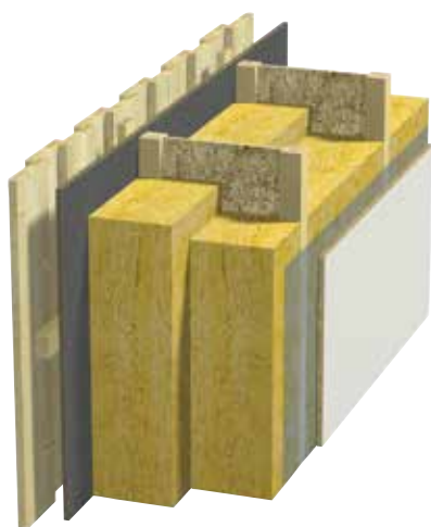
Fig. 3 Yttervegg Masonite stender, vindsperre 12mm trefiberplate
