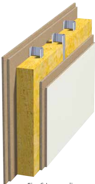
Fig. 6 Innvendig vegg. Forskjøvet stålstender med to platelag
