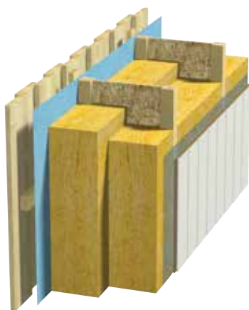
Fig. 1 Yttervegg Masonite stender. Vindsperre av folie
