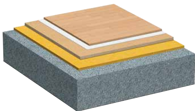
Fig. 1 Dekker. Flytende gulv på lettklinker
