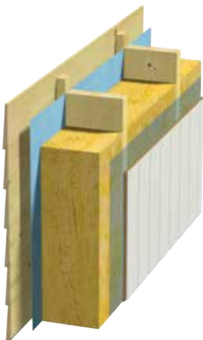
Fig. 5 Yttervegg Heltre stender, vindsperre av folie.
