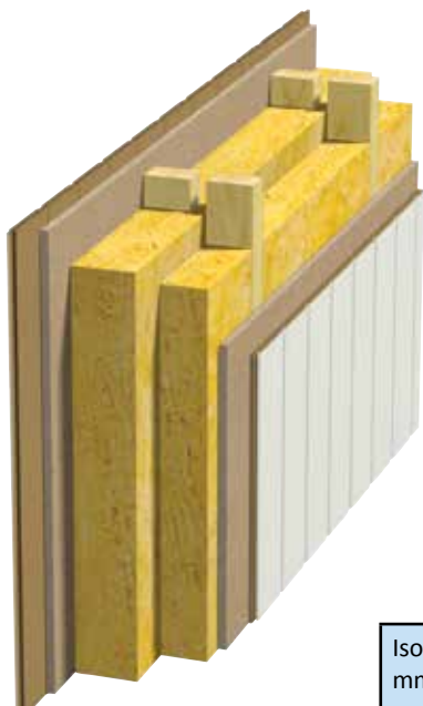
Fig. 4 Innvendig vegg. Dobbel heltre stender. To platelag.
